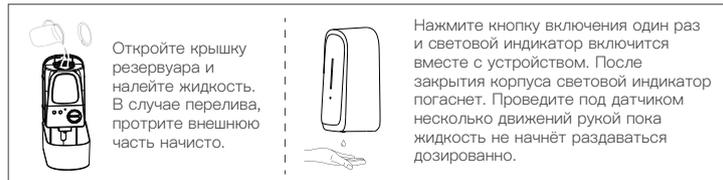
После установки устройство по умолчанию переходит в режим завершения работы. Чтобы активировать устройство нажмите кнопку включения и дозатор запустится. Световой индикатор непрерывно будет гореть белым монохромным светом.
