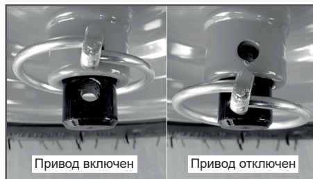
Рис.26 Перестановка шплинта на левом колесе
