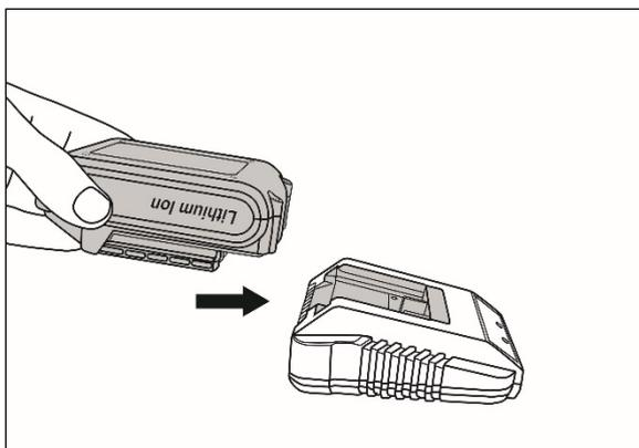
Рис 3. Установка батареи в зарядное устройство (слайдер)
