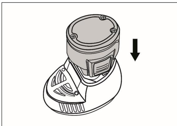
Рис 4. Установка батареи в зарядное устройство (обойма)
