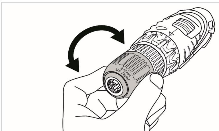
Рис. 8 Откручивание патрона
