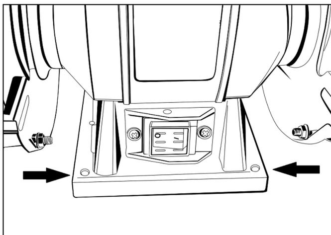
Рис. 7 «Крепление станка на верстаке»
