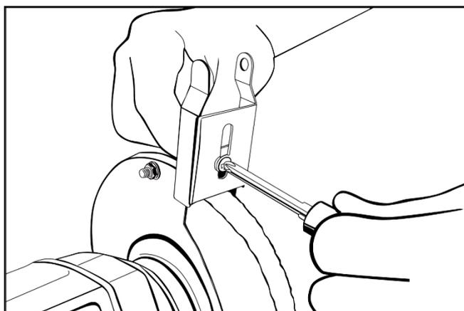
Рис. 2 «Установка искрогасителя»
