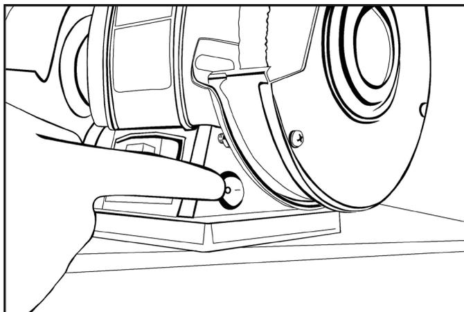
Рис.10 «Включение/выключение светильника»
