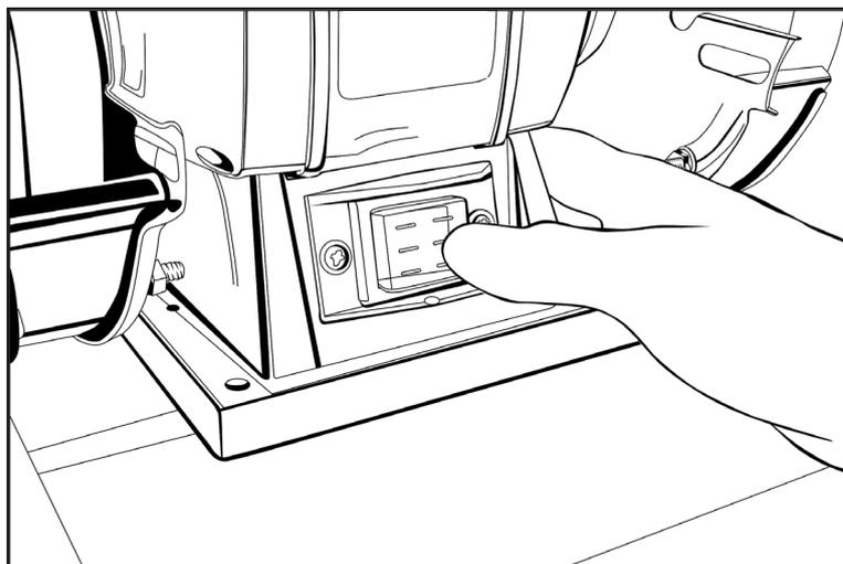
Рис. 9 «Включение/выключение станка»
