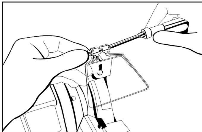
Рис. 4 «Установка защитного экрана»
