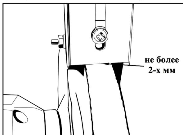
Рис. 3 «Регулировка искрогасителя»
