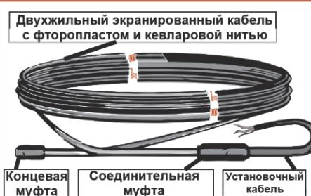
**Синий и коричневый** провода питания нагревательной секции подключаются к фазовому и нейтральному проводам питающей сети.
