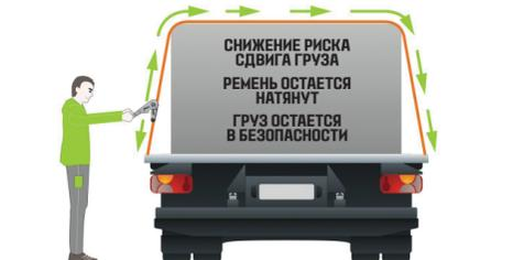
Подпружиненная система компенсирует потерю натяжения до 2 дюймов, сохраняя при этом ремень туго натянутым и надежно закрепив груз
