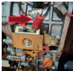
5. Включите декомпрессор (нажать рычаг и удерживать) и поверните ключ зажигания на старт.
