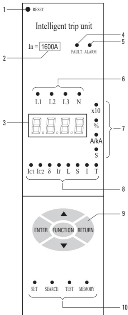
1. Кнопка-индикатор автоматического срабатывания от сверхтока и разрешения на включение автоматического выключателя только при взведенном приводе
