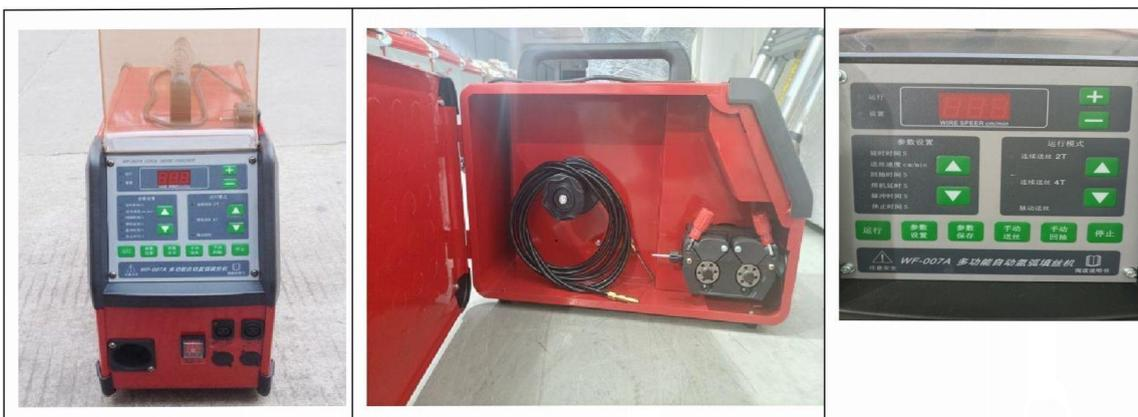
Подача сварочной проволоки осуществляется отдельным устройством. Работа податчика проволоки должна быть синхронизирована с остальными сварочными процессами и специальным оборудованием, чтобы дополнительно повысить скорость и качество автоматической интеллектуальной сварки и увеличить экономическую эффективность. Податчик проволоки представляет собой автоматическое механическое устройство,
