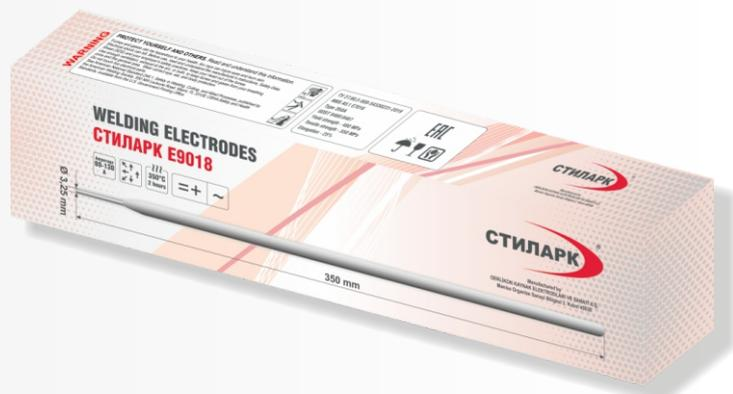
Электроды с основным видом покрытия Стиларк E9018 предназначены для сварки во всех пространственных положениях заполняющих и облицовочного слоёв шва труб и трубных узлов классом прочности до K60. Электроды обеспечивают высокие сварочно-технологические свойства, такие как легкий поджиг, стабильное горение дуги, формирование мелкочешуйчатого шва и легкое отделение шлаковой корки, а также стабильно высокие механические свойства сварных соединений в том числе ударную вязкость при температуре -40 °С.
