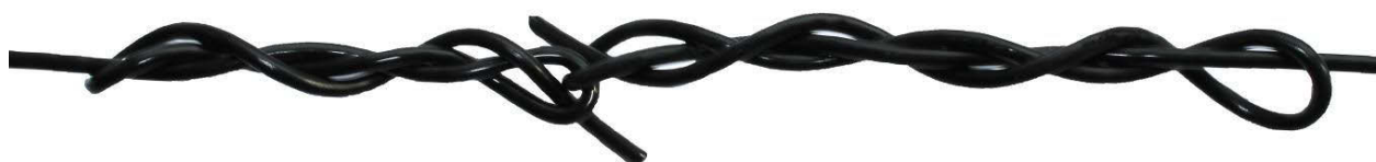
Соединения двух отрезков троса ремонтным узлом
