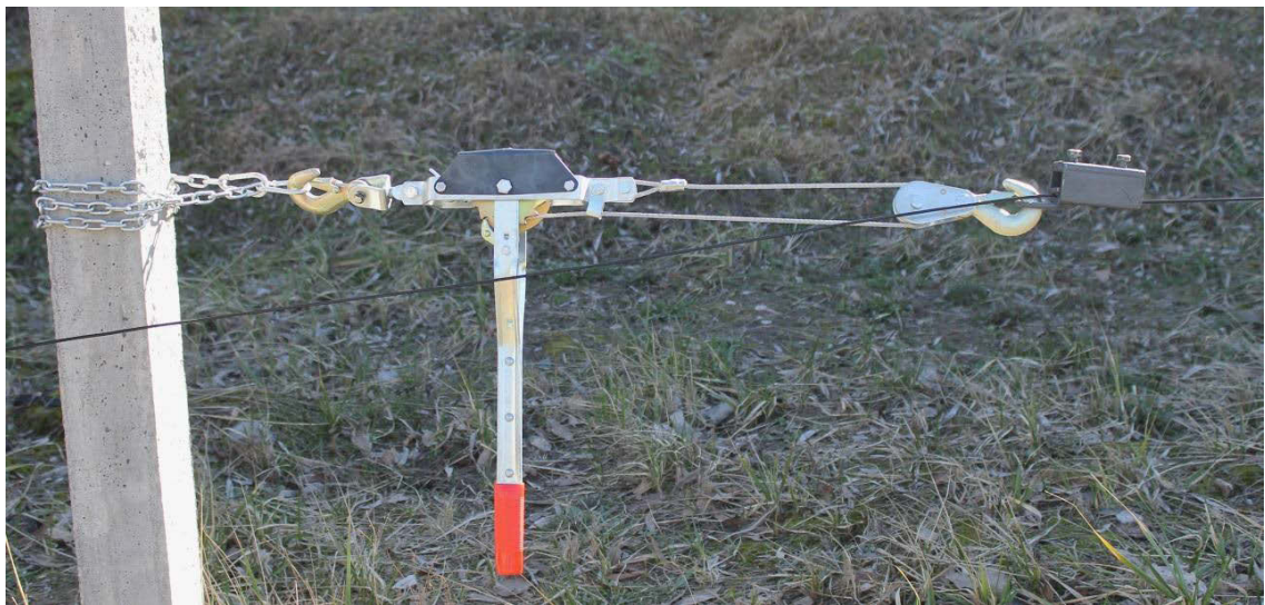
Натяжение шпалерного троса
