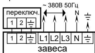
*Подключить сетевой кабель согласно маркировке рядом с клеммной колодкой*
