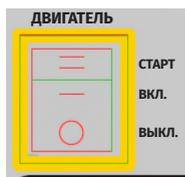
Установите переключатель двигателя в положение «ВКЛ., СТАРТ».
