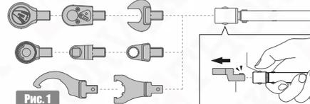
4.1 Установить вставку необходимого размера в гнездо динамометрического ключа, как показано на рис.1;
