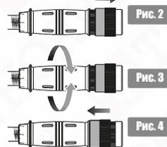
4.3 Провести 5-10 пробных измерений. После этого ослабить упругий элемент, выставив значение на «0». Используя алгоритм действий, описанный в п 4.2 установить требуемое значение крутящего момента, после чего динамометрический ключ готов к использованию.
