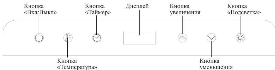
На панели управления расположены дисплей, кнопка «Вкл/Выкл», кнопка подсветки и кнопки регулирования времени и температуры. Все кнопки панели управления сенсорные.
