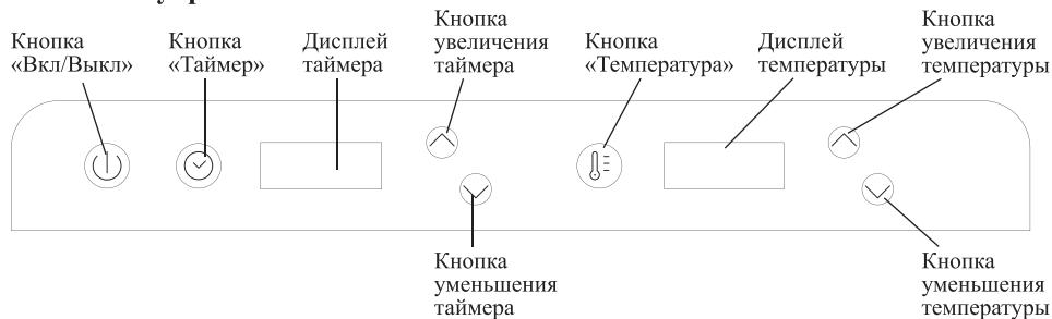
На панели управления расположены два дисплея, кнопка «Вкл/Выкл» и кнопки настройки времени и температуры. Все кнопки панели управления сенсорные.
