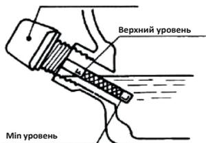
Снимите крышку маслозаливной горловины (щупа).
