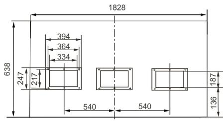
Схема расположения отверстий для болтов крепления воздуховода воздуховывпускного отверстия
