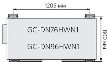
Рис. Установочные размеры для монтажный болтов
