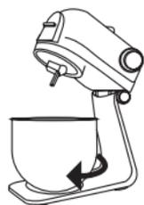
2. Поместите чашу с продуктами для смешивания в основание и плотно зафиксируйте ее, повернув до упора по часовой стрелке. Для Вашего удобства на корпусе прибора у основания для чаши нанесены обозначения «открыть – закрыть».
