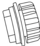
Если адаптер сломался, Вам необходимо выкрутить винт, снять адаптер, очистить место его расположения и поменять на новый (в комплекте находятся еще 4 сменных адаптера).
