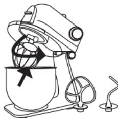
4. Установите необходимую Вам насадку (венчик для взбивания, крюк для замешивания теста, насадку для смешивания), нажав на нее снизу вверх и повернув против часовой стрелки до надежной фиксации. Мясорубку, овощерезку или блендер устанавливайте согласно разделу «ИСПОЛЬЗОВАНИЕ».
