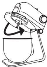
3. Присоедините прозрачную крышку к нижней части верхнего блока, повернув ее против часовой стрелки.
