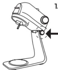
1. Для установки прозрачной крышки, необходимой насадки и чаши слегка нажмите на верхний блок вниз, а затем на подъемную кнопку-рычаг (см. стрелку на рисунке). После этого блок поднимется.
