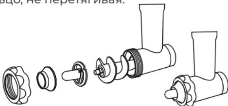
5. Присоедините подготовленную мясорубку к блоку установки, повернув ее против часовой стрелки.
