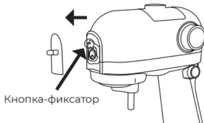
2. Соедините блок овощерезки с необходимой теркой или шинковкой, присоедините собранную овощерезку к блоку установки прибора, повернув ее против часовой стрелки.
