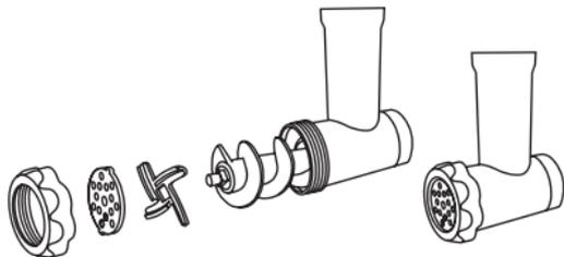
**\*Сменный адаптер для мясорубки** – это переходник, принимающий на себя всю мощь случайно попавших в блок прибора твердых предметов – обломков костей, фруктовых косточек и пр. В случае отсутствия подобного адаптера страдают редуктор и мотор прибора. Чтобы Вам не отказывали в гарантии из-за механического повреждения, был создан данный аксессуар.
