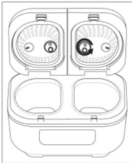
3. Осторожно снимите уплотнительное кольцо парового клапана, потянув его на себя.
