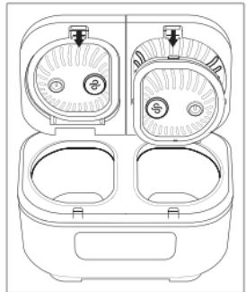
2. Снимите паровой клапан, повернув его против часовой стрелки и потянув на себя.
