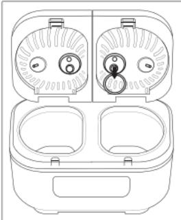
4. Аккуратно промойте клапан и кольцо вручную в мыльной воде, затем в проточной и просушите.
