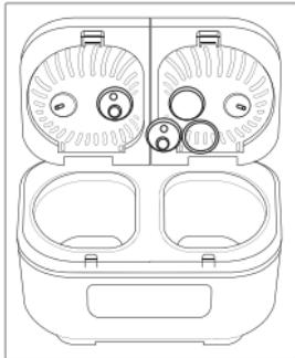
2. Вставьте паровой клапан в гнездо, повернув его по часовой стрелке.
