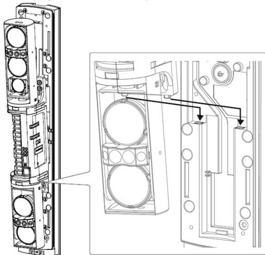
Поверните оптический блок на 90 градусов и зафиксируйте винтами (с двух сторон)
