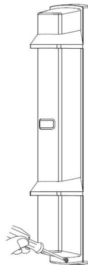
③ Затяните винт блокировки крышки
