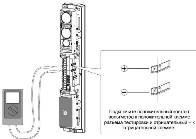
Произведите выравнивание по горизонтали и по вертикали путем контроля звукового и светового индикаторов тревоги.
