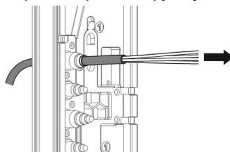
Зафиксируйте провод при помощи хомута
