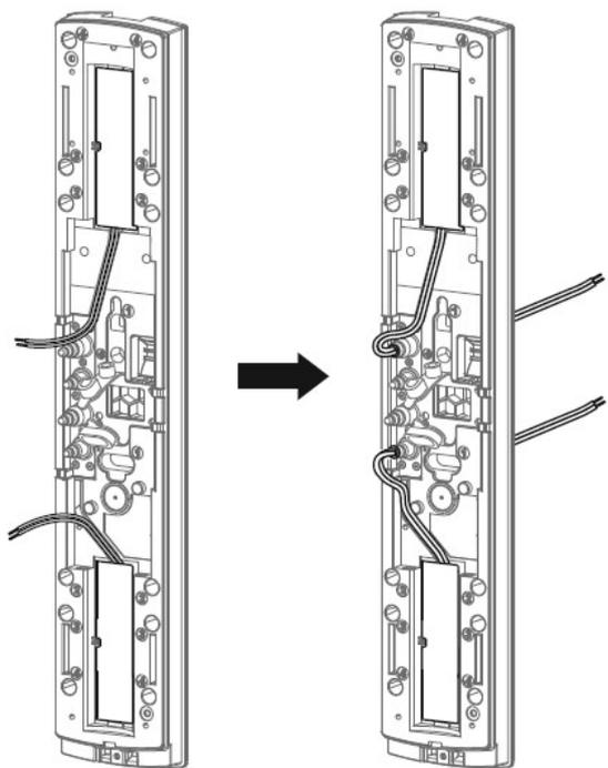
Для подключения питания используйте соединители, входящие в комплект поставки, либо пайку. Поместите провода в соединитель и зажмите его плоскогубцами.
