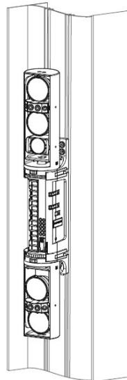
При установке извещателя без крышки закройте кнопку тампера пластиной как на передатчике, так и на приемнике
