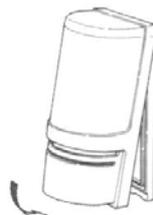
После проверки оптической регулировки и операций настройки (см. п. 5 "Оптическая настройка") установите крышку на место и зафиксируйте винтом.
