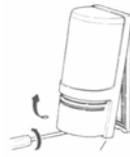
Винт крепежа крышки
