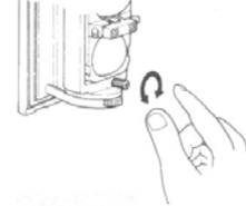
Глядя через видоискатель, поворачивайте колесо вертикальной настройки пальцами или отверткой
