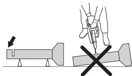
Если позволить трубе провиснуть и закрыть разрез, лезвие будет защемлено в зоне отдачи, и может развиться сильный отскок. Если труба правильно закреплена, конец трубы сдвинется вниз, разрез откроется и защемления не произойдет.
