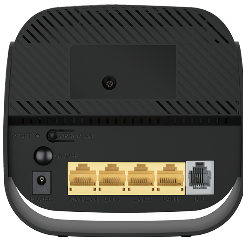
Рисунок 2. Вид задней панели DSL-2640U.
