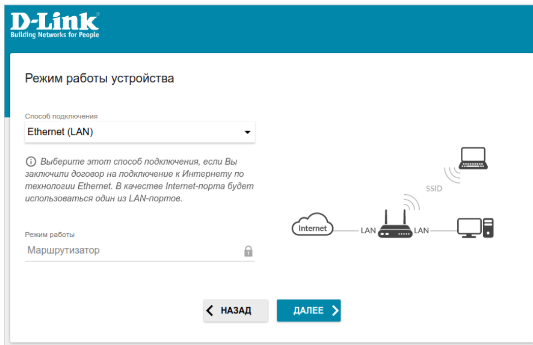
Рисунок 24. Выбор режима работы устройства. Режим Ethernet (LAN) .
