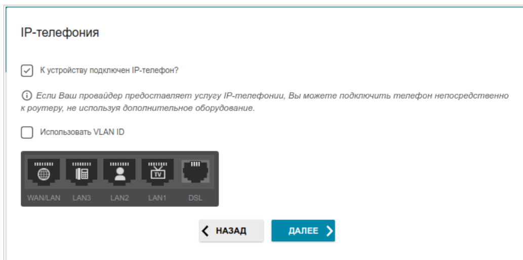
Рисунок 32. Страница выбора LAN-порта для подключения VoIP-телефона.
