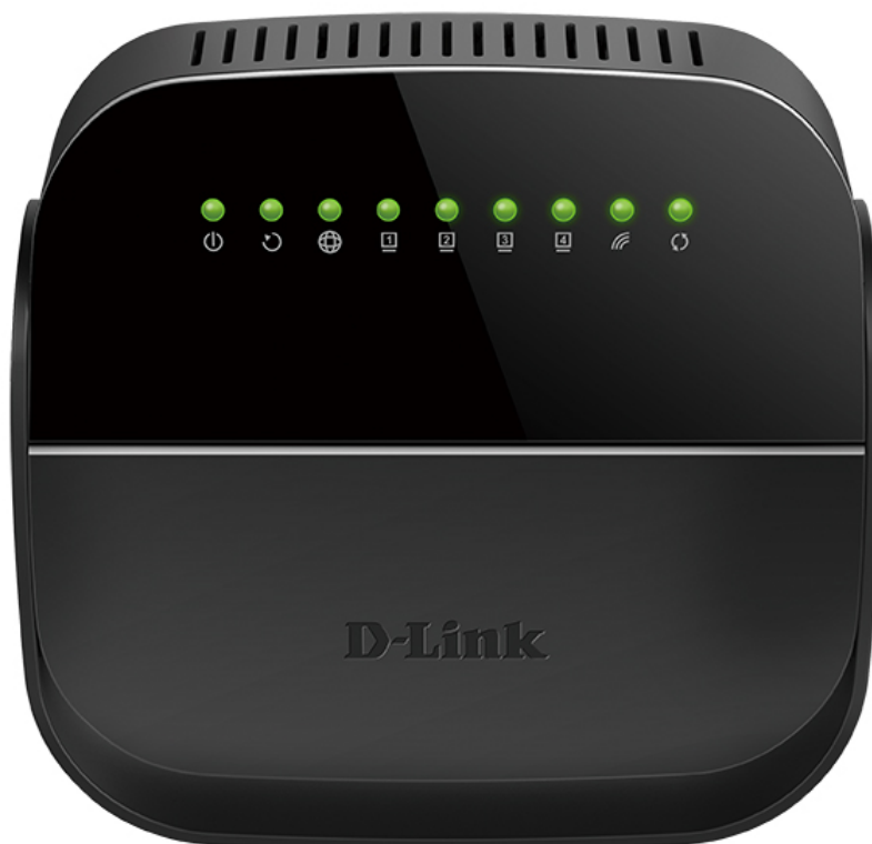
Рисунок 1. Вид передней панели DSL-2640U.
