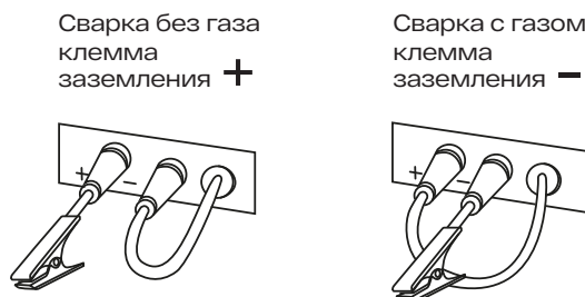
Рис. 19. Полярность при полуавтоматической сварке
