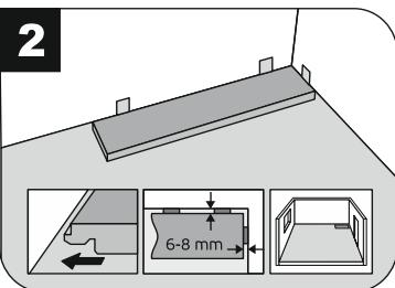
Необходимо соблюдать монтажные деформационные зазоры: не менее 6-8 мм от края покрытия до стен. Укладка кварцевого ламината начинается с формирования первого «маякового» ряда. От ровности его монтажа зависит ровность и качество всей укладки.
