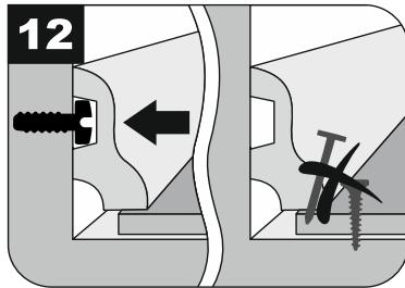
Плинтус крепится к стене. Следите за тем, чтобы плинтус не был жёстко закреплён на поверхности кварцевого ламината — это может привести к деформации покрытия.
