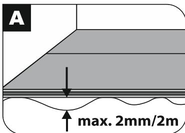
Неровности основания, превышающие 2 мм на 2 м длины укладки, должны быть устранены до начала монтажа кварцевого ламината.
