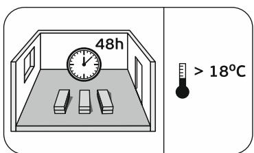
Перед укладкой обеспечить хранение кварцевого ламината в горизонтальном положении в упаковке в течение 48 часов при температуре воздуха не менее 18 градусов. Упаковку (плёнку) вскрывать непосредственно перед укладкой. После укладки необходимо проветрить помещение.
