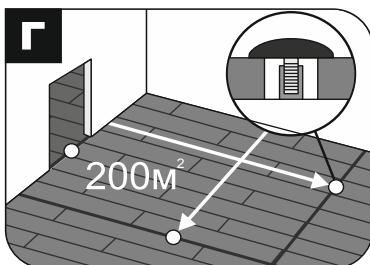
В помещениях площадью больше 200 кв.м необходимо предусмотреть деформационные зазоры не менее 6-8 мм. Рекомендуется использовать деформационные зазоры в проёмах дверей. После укладки кварцевого ламината деформационные зазоры закрываются накладным порогом.
