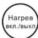
4. После окончания подачи воды в чайник нажмите кнопку над этой кнопкой и начнётся нагрев воды в чайнике. **До включения функции нагрева обязательно проверяйте наличие воды в чайнике!** При отсутствии воды в чайнике и включённом нагреве, индикатор будет гореть, но сам нагрев происходит не будет.
