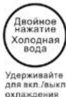
2. Дважды нажмите кнопку подачи холодной воды – над кнопкой замигает индикатор, вода будет автоматически поступать в бак охлаждения и через 28 секунд (индикация на табло) насос отключится. Повторяйте эту операцию до тех пор, пока из крана не пойдёт вода. Для того чтобы остановить подачу холодной воды – нажмите на кнопку подачи холодной воды один раз.
