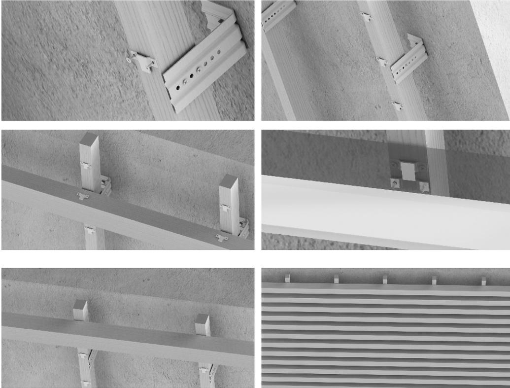
**Расход крепежа Дуплекс Т:** для соединения двух монтируемых поверхностей потребуется 2 шт. крепежа Дуплекс. Количество крепежа соответствует количеству точек пересечения монтируемых поверхностей, взятых дважды. Упаковка 200 шт (100 пар) рассчитана на монтаж деревянного потолка площадью около 10 м<sup>2</sup>.
