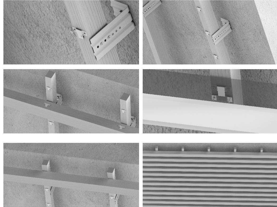
**Расход крепежа Дуплекс Т:** для соединения двух монтируемых поверхностей потребуется 2 шт. крепежа Дуплекс. Количество крепежа соответствует количеству точек пересечения монтируемых поверхностей, взятых дважды. Упаковка 200 шт (100 пар) рассчитана на монтаж деревянного потолка площадью около 10 м<sup>2</sup>.
