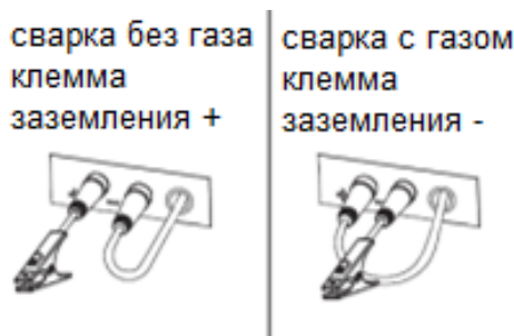
Рисунок 15. Полярность при полуавтоматической сварке
