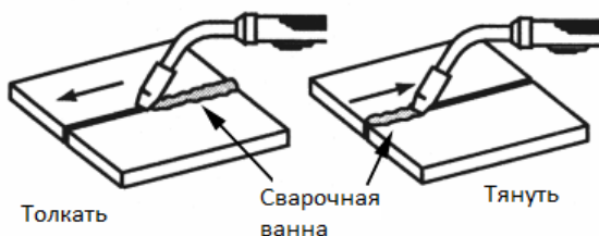
Рисунок 18. Направление движения горелки
