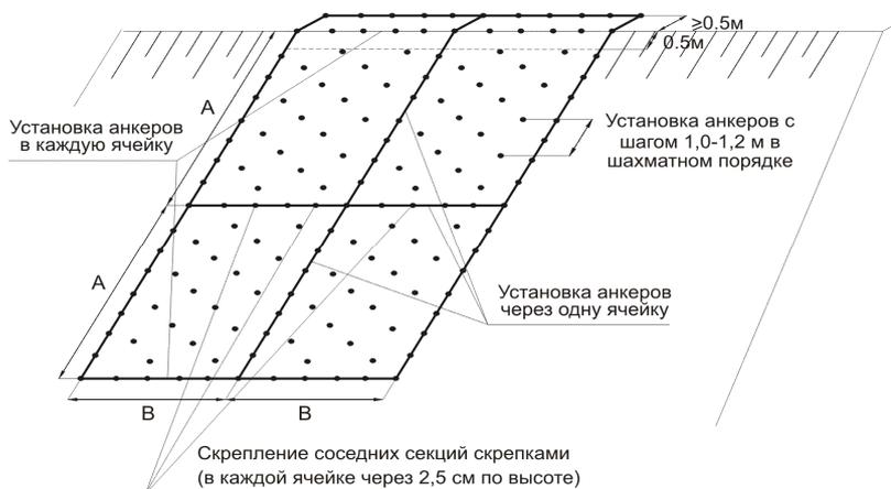
Рис. 20 – Схема расположения анкеров и объемной георешетки
