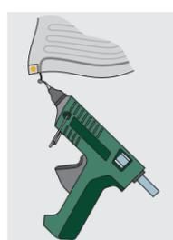
**Второй способ:** разогрейте клеевой пистолет с клеевым стержнем для склеивания пластмасс. Нанесите небольшое количество клея на тупиковый конец магистрали и дайте ему затвердеть.
