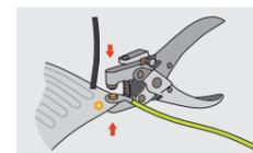
Обожмите эту конструкцию люверсовщиком со значительным усилием для того, чтобы обеспечить надежное соединение и контакт.
