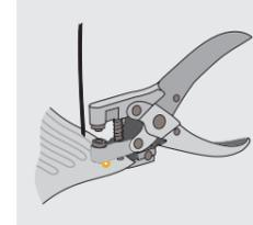
Для установки с помощью люверса вам потребуется специальный инструмент – люверсовщик, предназначенный для люверсов диаметром 4,8 мм. Осторожно, чтобы не повредить магистральный провод, пробейте дыроколом люверсовщика отверстие в углу нагревательной ленты. Предварительно потренируйтесь пробивать отверстие
