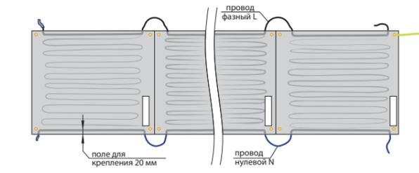
Поле шириной 20 мм от бокового края нагревателя до фазного или нулевого провода предназначено для крепления нагревателя к потолочной поверхности.
