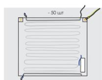
Из одной коробки вы можете нарезать следующие нагреватели: единичные нагреватели размером 595x485 мм; двойные размером 1190x485 мм; тройные 1785x485 мм и так далее с шагом 595мм, то есть в один нагреватель. Предельная (максимальная) длина одной ленты составляет 6 метров, или десять модулей.
