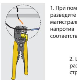
1. При помощи КСИ разведите изоляцию на магистральном проводе напротив соответствующего вывода.
