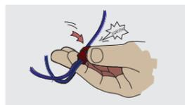
Коммутация этого соединения закончена. Аналогичную операцию нужно произвести с каждым проводом, соблюдая соответствие цветов проводов и выводов – все черные/коричневые провода коммутируем с черной магистралью, синие с синей и желто-зеленые с желто-зеленой.
