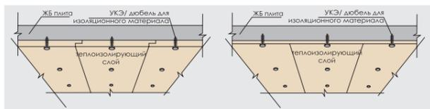
Крепление теплоизоляции можно осуществлять с помощью саморезов и шурупверта или при помощи скоб и мебельного степлера. Рекомендуем использовать саморезы с пресс-шайбой 4,2x19–4,2x25.
