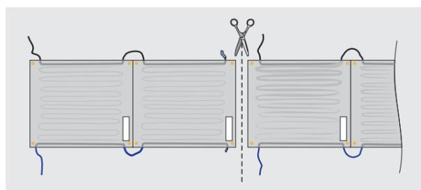
Изолирование тупикового конца магистрального провода может производиться двумя способами – при помощи ТУТ или клеевым пистолетом.
