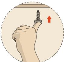
Следующий этап: поверх теплоизоляции аналогично крепим отрезки нагревателей. Для этого просверливаем сквозь плиту для крепления нагревателя отверстие буром 7,0 мм.
