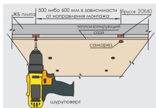
Следующим этапом монтируются ленты нагревателей при помощи шурупверта или мебельного степлера.
