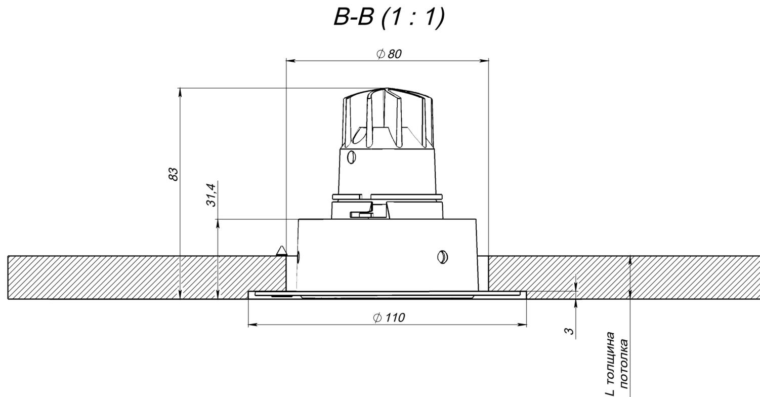
Габаритные размеры монтажного отверстия в потолке
