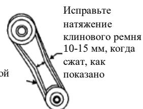
Рисунок 2. Натяжение клинового ремня
