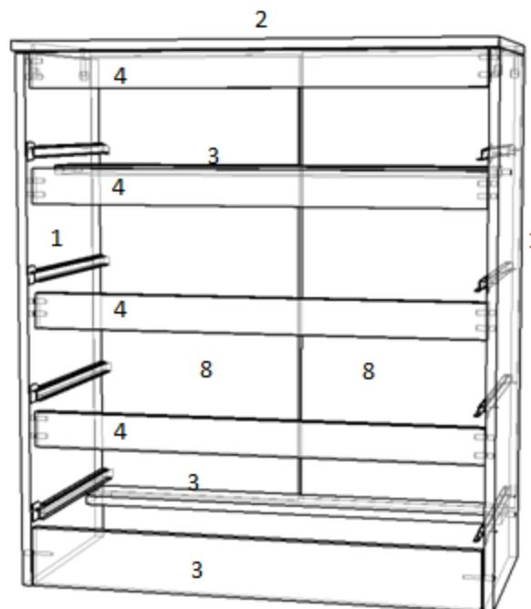
К детали 1 привернуть направляющие колесиком вперед. Прибить гвоздями подпятник. В готовые отверстия вставить шкант 8\*30. Евровинтами скрепить детали 1 и 3 предварительно установить планку 4 на шканты. Ввернуть шток эксцентрика в деталь 2 и скрепить крышку с боковинами замком эксцентрика.
