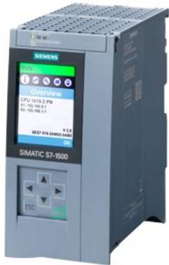
SIMATIC S7-1500, центральный процессор CPU 1515-2 PN, ЦПУ с рабочей памятью 500 кБ для программы и 3 МБ для данных, 1ый интерфейс: PROFINET IRT с 2х-портовым коммутатором, 2ой интерфейс: PROFINET RT, производительность 30 нс на битовую операцию, для работы нужна карта памяти SIMATIC MC
