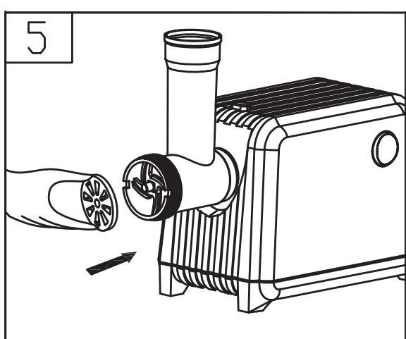
• Убедитесь, что паз на решетке точно совмещен с фиксатором на головке мясорубки.
