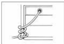
2. Кабель питания оберните 2-3 раза вокруг трубы рамы генератора.
