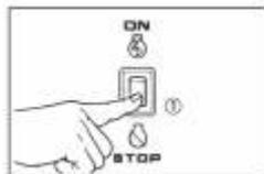
3. Переведите переключатель в положение Выключено (1) (Клавишный переключатель на моделях с электрическим стартером переводится в положение ВЫКЛ)
