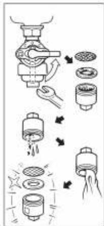
1. Снимите фильтр топливного крана.
