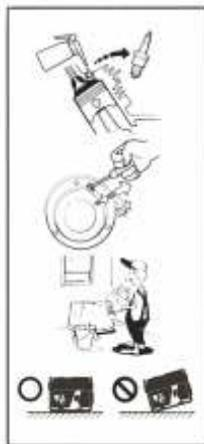
4. Снимите свечу зажигания и залейте в через образовавшееся отверстие 1 чайную ложку масла, несколько раз дерните шнур стартера при выключенном двигателе и установите свечу обратно. Затем потяните стартер, пока поршень не войдет в такт сжатия, и оставьте его в таком положении. Это способствует закрытию входного и выпускного клапанов, что необходимо для предотвращения коррозии цилиндра.
