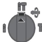
Для **сверления без удара** (режим дрели) в дереве, металле, керамике и пластике установите переключатель режимов работы в положение
