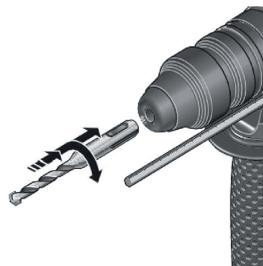
Для замены оснастки оттяните фиксирующую втулку в сторону корпуса перфоратора и удерживайте ее в таком положении. Извлеките сменный инструмент. Отпустите фиксирующую втулку.
