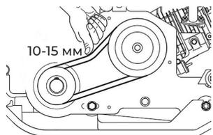
Внешним осмотром убедитесь в отсутствии на ремне следов износа или повреждения (трещин, порезов, расслоений, разломачивания краев, разделения на пряди и проч.).
