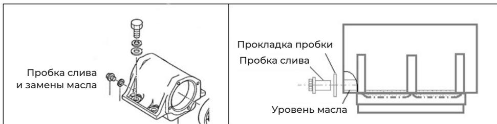
Снять пробку вместе с прокладкой, проверить, что уровень масла достигает нижней части резьбы в отверстии масляной пробки.
