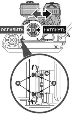
При необходимости, произведите регулировку натяжения ремней. Регулировка натяжения ремней: для натяжения ремней - перемещением двигателя от вибратора; для ослабления ремней – перемещением двигателя к вибратору. Затяните болты крепления двигателя.
