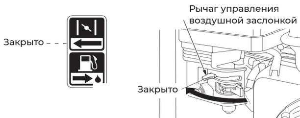
Это ограничит подачу воздуха, и создаст более бензинообогащенную топливную смесь, что облегчит запуск холодного двигателя.
