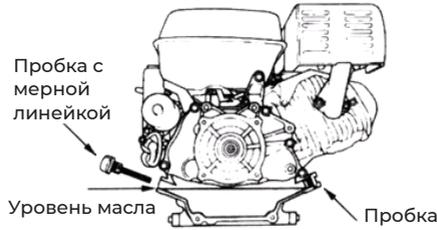
3. Проверьте уровень масла в картере двигателя. Снимите пробку-щуп с горловины заправки масла. При наличии следов масла на щупе, проверьте уровень масла в картере: протрите щуп чистой сухой ветошью, установите щуп на место и снова выньте. Если уровень масла достаточен (между минимальной и максимальной метками щупа), доливать масло не следует. Если уровень масла недостаточен, долейте масло, соответствующее по марке уже залитому. Плотнo закрутите крышку-щуп.
