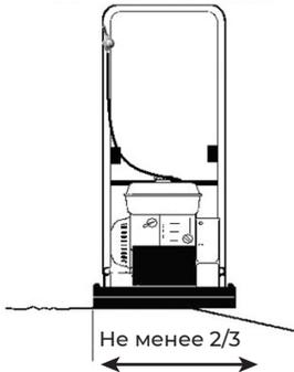
При перемещении в местах, где поверхность с сильным уклоном, необходимо, чтобы две трети части рабочей площади плиты находилось на твердой поверхности.
