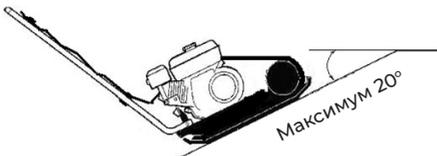
Запрещается работа на склонах, угол которых превышает возможности виброплиты. Максимальный рабочий угол положения виброплиты составляет 20° (зависит от состояния грунта).
