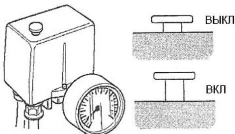
Модель Pacific 100-720 оснащена кабелем питания без вилки. Подключите его к однофазному источнику сети 220 – 240 В, 50 Гц, обеспечивающему силу тока не менее 25 А. Для этого используйте силовую вилку питания не менее 25 А. Данная модель компрессора комплектуется специальным блоком управления двигателями, на котором расположен выключатель общего питания компрессора, кнопки индивидуального включения каждого из трех двигателей, индикаторы работы двигателей и дисплей контроля напряжения в сети.
