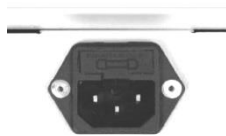
Разъем питания вентиляторного блока с терморегулятором и датчиком
