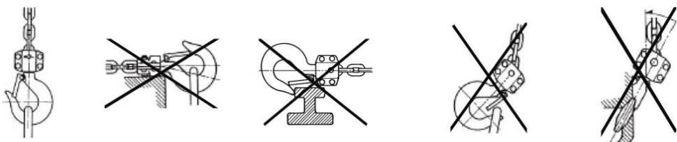
6.11. Запрещено поднимать груз с помощью двух талей. Используйте таль нужной грузоподъемности.
