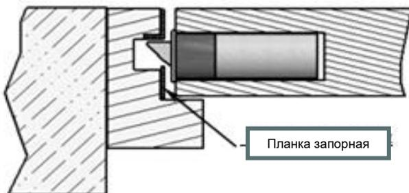
Для установки замка просверлите 4 отверстия диаметром 2-2,5 мм для крепления саморезов замка и планки запорной, и диаметром 30-32 мм для установки замка.
