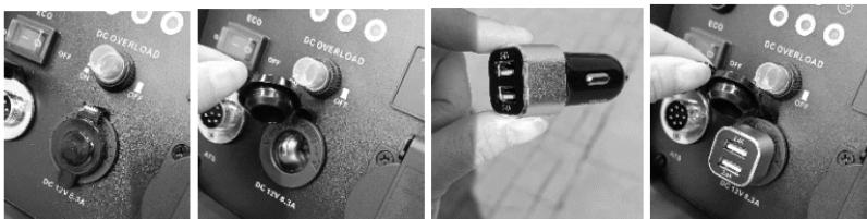
Разъём оборудован автоматом защиты.
