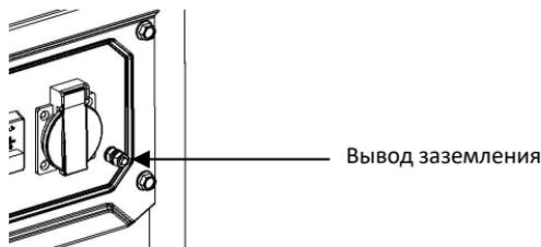
Выход заземления — это специальная клемма, используемая для заземления всего генератора.
