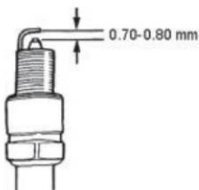
**ПРИМЕЧАНИЕ!** Пожалуйста, используйте свечи зажигания с соответствующей теплотворной способностью.
