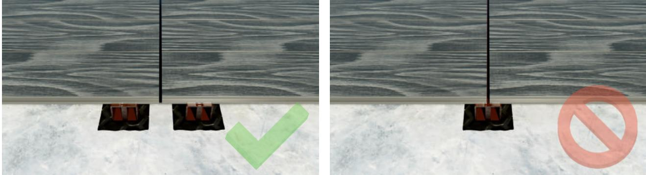
При монтаже в холодную температуру (ниже 5 °C) требуется предварительно просверлить опорные лаги в местах крепления кляймеров.
