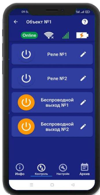
Для того, что бы включить или выключить реле, нажмите и удерживайте в течении 2-х секунд кнопку реле (например: реле №2), в случае успешного сохранения настроек на экране на 2 секунды появиться окно подтверждающее выполнение команды, а кнопка выбранного реле сменит цвет. Аналогично выполняется выключение реле.
