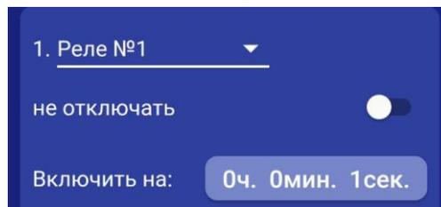
«Не отключать» - если выбран данный режим, то при тревоге выход включится, и отключить его можно, только отправив команду sms или через приложение на телефоне на отключение выхода (используется, например, при управлении электроприводами, перекрывающими воду или газ при тревоге).
