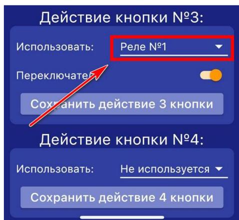
С помощью 3 и 4 кнопки пульта можно управлять одним из выходов прибора, как проводным, так и беспроводным. В поле «Использовать» нужно выбрать выход которым необходимо управлять.
