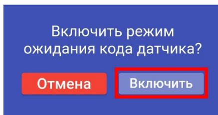
**ВНИМАНИЕ!!!** Перед записью датчиков переведите выключатели всех имеющихся датчиков в положение «Выключено» или отключите их питание, вынув элемент питания (батарейку). Наличие постороннего сигнала в момент записи может привести к тому, что код нужного датчика не будет записан в память прибора или записан неверный код.
