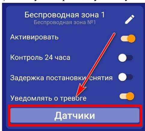
Откроется меню для работы с беспроводными датчиками, для добавления нового датчика, нажмите на кнопку «Добавить». В появившемся окне, нажмите кнопку «Включить», это значит, что прибор будет ожидать код датчика. Если вы не планируете записывать датчик, нажмите «Отмена».
