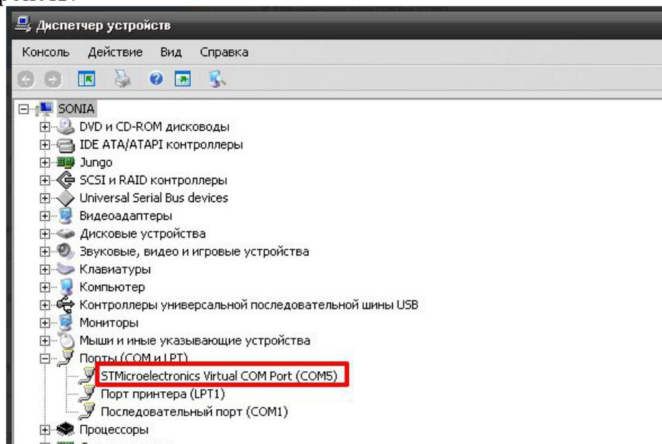
**Если прибор не определяется в диспетчере устройств** - попробуйте отключить питание и аккумулятор на приборе, индикатор должен погаснуть, и через 5-10 секунд подключите обратно. Попробуйте установить конфигурактор заново, смените com-порт и USB-шнур.
