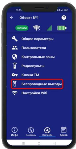
Откроется меню для работы с беспроводными выходами, для добавления нового реле или розетки, переведите устройство которое вы хотите привязать в режим записи кода (как это сделать см. в инструкции на устройство), выберите тип записываемого устройства и если вы хотите добавить «ИПРо Радиореле» то нажмите на кнопку «Привязать», а для добавления «ИПРо радиорозетки» нажмите «Включить» затем «Выключить»
