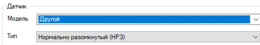
Далее выберите модель датчика из представленных в списке. В таком случае, программа автоматически выберет тип проводной контрольной зоны (Нормально-замкнутый или
