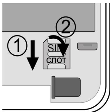
Установите sim-карту в слот и закройте его крышку, сдвинув её вверх:
