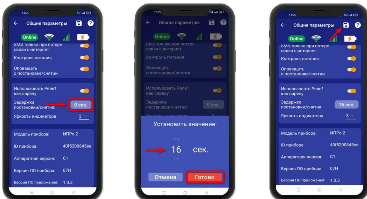
Это значит, что при касании считывателя ключом ТМ, прибор начинает отсчет 16 секунд, за которые люди должны покинуть помещение, и после переходит в режим «Охрана».
