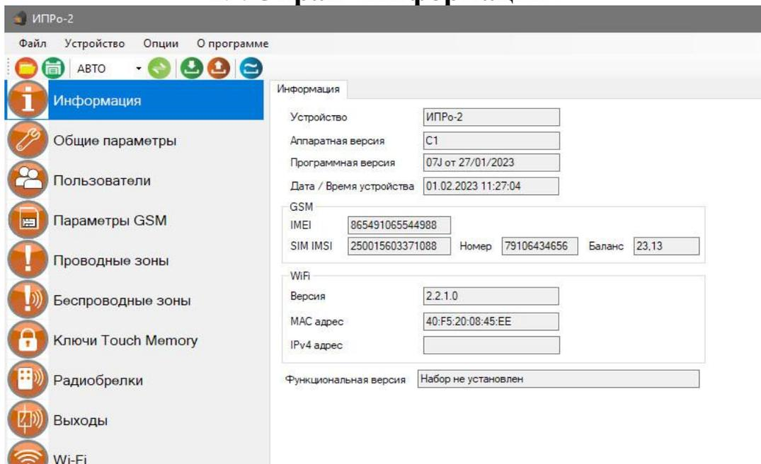
В данном экране можно посмотреть версию программного обеспечения и аппаратную версию прибора, IMEI прибора, номер и баланс sim-карты, MAC адрес Wi-fi модуля.
