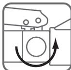
6. Отвернуть на пол-оборота запорный клапан, при этом поршень возвращается в исходное положение.
