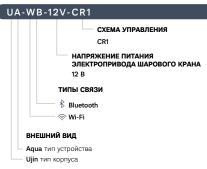
Артикул соответствует модели «Контроллер протечки UJIN WiFi/BLE 12B CУ-01»
