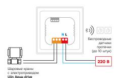
Рекомендуемое сечение кабеля для подключения питания к контроллеру 1.5 мм²
