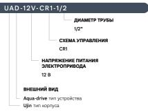
Артикул соответствует модели «Моторизированный шаровый клапан 1/2 дюйма модели CWX-25S с электроприводом UJIN 12B, CУ-01»
