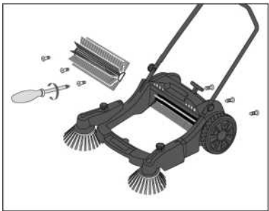
Сборка и разборка основной щётки. Основная щётка состоит из 2х частей, каждая из которых закреплена тремя винтами.
